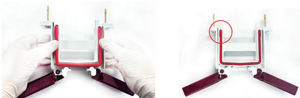
4. 按下图所示方法将预制胶安装到电泳装置中；
