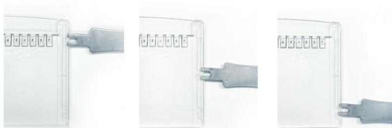
(3) 胶板撬开之后, 凝胶可能还会粘在其中一块胶板上, 只需将胶板附着凝胶的一侧浸入水中, 贴着水面将其倾斜轻轻提起, 凝胶即可脱离, 将凝胶从水中取出进行后续实验。
